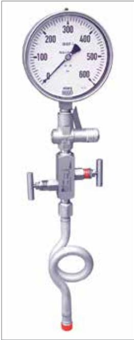
Das Manometer Hook-up mit Überdruckschutzvorrichtung, Nadelventil und Wassersackrohr kann mit minimalem Aufwand in den Prozess integriert werden.
