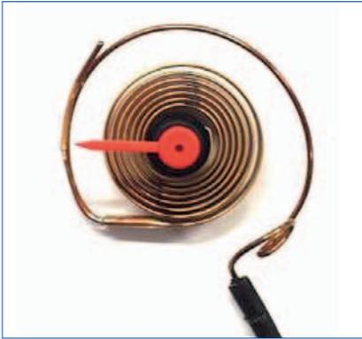
**Aufbau eines Tensionsthermometers**
