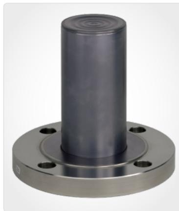
**Dieser Druckmittler (Typ 990.29) mit vorgezogener frontbündiger Membran eignet sich besonders für dicke oder isolierte Rohrleitungen. Die medienberührten Bauteile sind aus Tantal.**
