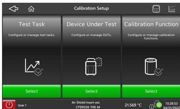
In questo sottomenu possono essere impostati i tipi di prova, lo strumento in prova e le funzioni di taratura.
