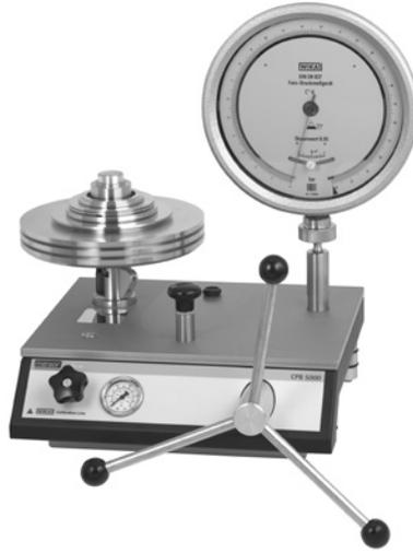
**Kolbenmanometer CPB5000 mit Prüfling**
