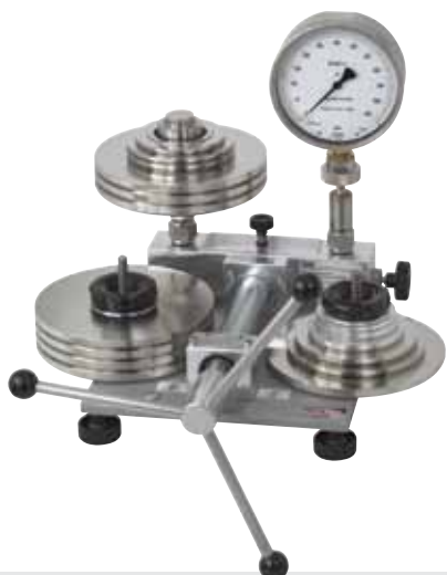
Prasa manometryczna CPB3000 z urządzeniem testowym
