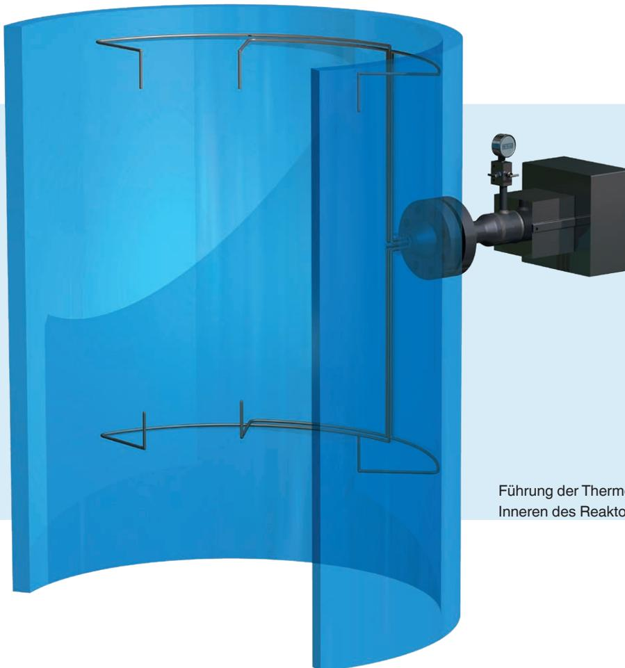
Führung der Thermoelemente im Inneren des Reaktors
