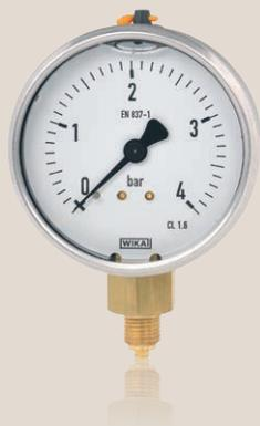
Das Rohrfedermanometer des Typs 113.53 ist mit einem CrNi-Gehäuse ausgeführt. Mit seiner Flüssigkeitsfüllung ist es für den Einsatz an Messstellen mit hoher dynamischer Druckbelastung und starken Vibrationen geeignet.
