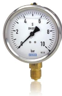
Das Rohrfederanometer Typ 213.53 in einem CrNi-Gehäuse eignet sich für die Druckanzeige bei erhöhten Messstofftemperaturen. Die Flüssigkeitsfüllung sorgt für eine hohe Anzeigegenauigkeit bei dynamischen Druckspitzen und Vibrationen.
