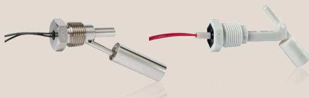
Der HLS-M ist ein wartungsfreier Schwimmer-Magnetschalter mit kompakten Abmaßen für den seitlichen Einbau in kleinen bis mittelgroßen Behältern. Er kann als Öffner oder als Schließer verwendet werden. Der HLS-M kann in CrNi-Stahl oder Kunststoff ausgeführt werden und ist für die Behältermontage von innen oder von außen geeignet.
