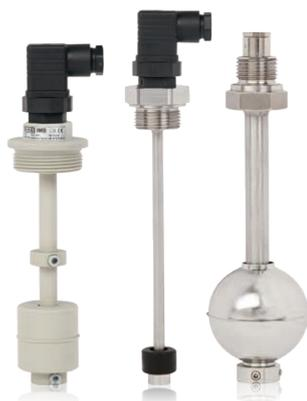
Der RLS ist ein berührungsloser Schwimmer-Magnetschalter für den Vertikaleinbau in mittleren bis großen Behältern. Er kann als Öffner, Schließer oder Wechsler mit bis zu vier Schaltpunkten in individueller Höhe ausgeführt werden. Für den Schwimmer stehen verschiedene Geometrien und Materialien zur Verfügung.
