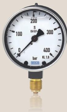
Das Rohrfederanometer vom Typ 213.40 ist mit einem Pressmessinggehäuse ausgerüstet. Daher ist es äußerst robust gegenüber mechanischen Belastungen. Mit seiner Flüssigkeitsfüllung ist es für den Einsatz an Messstellen mit hoher dynamischer Druckbelastung und Vibrationen geeignet.
