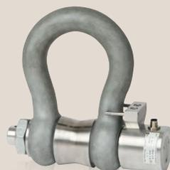
Der F5302 ist ein Lastmessschäkel für die statische und dynamische Zugkraftmessung. Der Kraftaufnehmer ist eine hochfeste Edelstahlmessachse mit eingeschweißten Dünnsensorelementen. Die Abmessungen sowie die Handhabung des F5302 entspricht denen von Standardschäkeln. Dadurch ist die universelle Verwendung auch in bestehenden Systemen gewährleistet.
