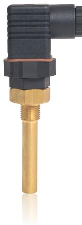
Der TSF35 ist ein Bimetall-Temperaturschalter und kann als Öffner oder Schließer ausgeführt werden. Auf Grund seiner hohen übertragbaren elektrischen Schaltleistung kann er ohne zwischengeschaltetes Relais in einen Verbraucherstromkreis eingebaut werden. Dadurch ist weder eine zusätzlich Spannungsversorgung noch ein Signaleingang an einer Steuerungselektronik erforderlich.
