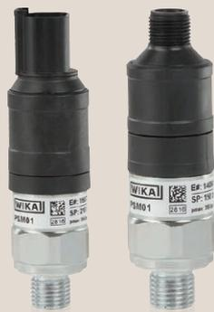
Der PSM01 ist die wirtschaftliche Lösung, um in einer mobilen Arbeitsmaschine Schaltfunktionen zu realisieren. Er ist ein hochwertiger Federschnappschalter mit selbstreinigenden Kontakten und kann als Öffner, Schließer oder auch als Wechselschalter ausgeführt werden. Sein Schaltpunkt kann einfach über eine Einstellschraube individuell eingestellt werden. Das kompakte Design des PSM01 erlaubt die Montage auch an schwer zugänglichen Stellen, insbesondere auch mit Steckschlüssel.
