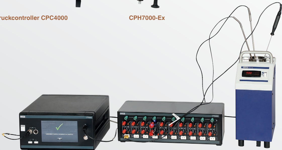
Präzisionsthermometer CTR3000 mit Messstellenumschalter CTS3000
